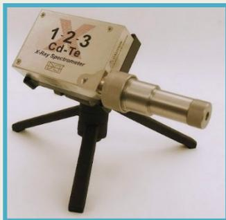
Спектрометр рентгеновского и низкоэнергетического гамма излучения с CdTe детектором от компании AMPTEC.
