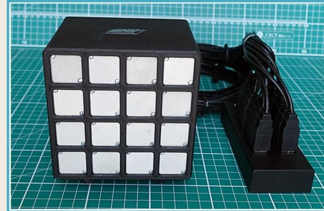
16-и элементный кластер с микроспектрометрами  $\mu$ SPEC1500. Суммарный объем детекторов  $25.6 \text{ см}^3$
