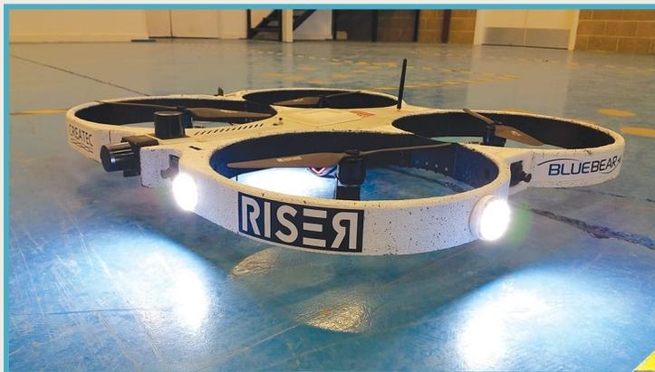
RISER – устройство для дистанционного обнаружения и исследования источников радиации от компании CREATEC Ltd.
