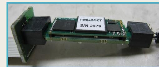
Модуль многоканального анализатора
