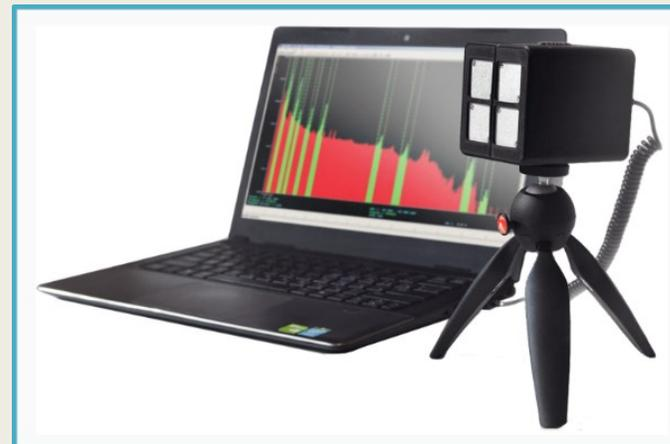
Для сбора и обработки полученных спектров от кластерного спектрометра используется специальное программное обеспечение WinSPECx16 на базе MS Windows, разработанное компанией GBS-Elektronik GmbH
